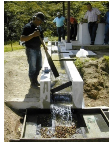
Instalación de beneficio por vía húmeda que no daña el medio ambiente promovida por los proyectos OIC/FCPB en Centroamérica
